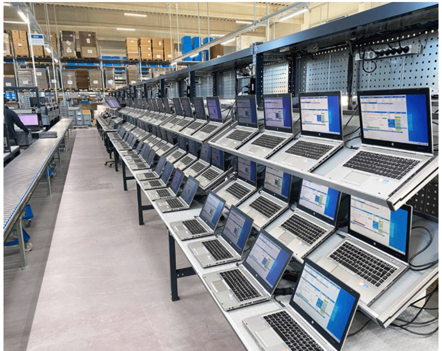
Blick in die IT-Aufbereitung bei bb-net in Schweinfurt: Mehr als 100.000 Geräte pro Jahr werden hier generalüberholt und zurück in den Markt gebracht – Tendenz steigend.
